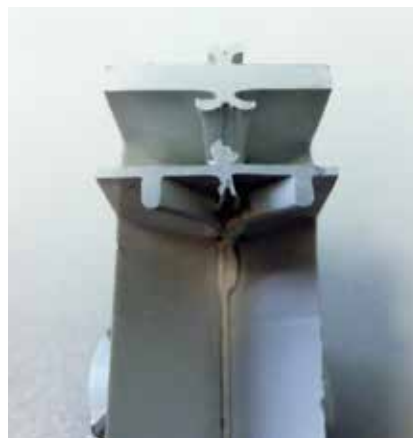
Abb. 12: Ergebnis der Schweißraupenbegrenzung im Profilschnitt (l.) | Schweißraupenbegrenzung in der Schweißmaschine (r.)
