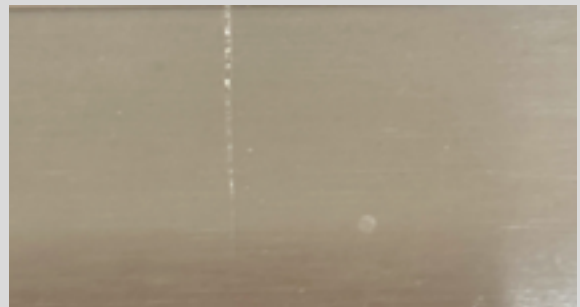
Spannungsrisse auf einer Acrylat (PMMA) Oberfläche, verursacht durch lösemittelhaltige Reinigungsmittel
