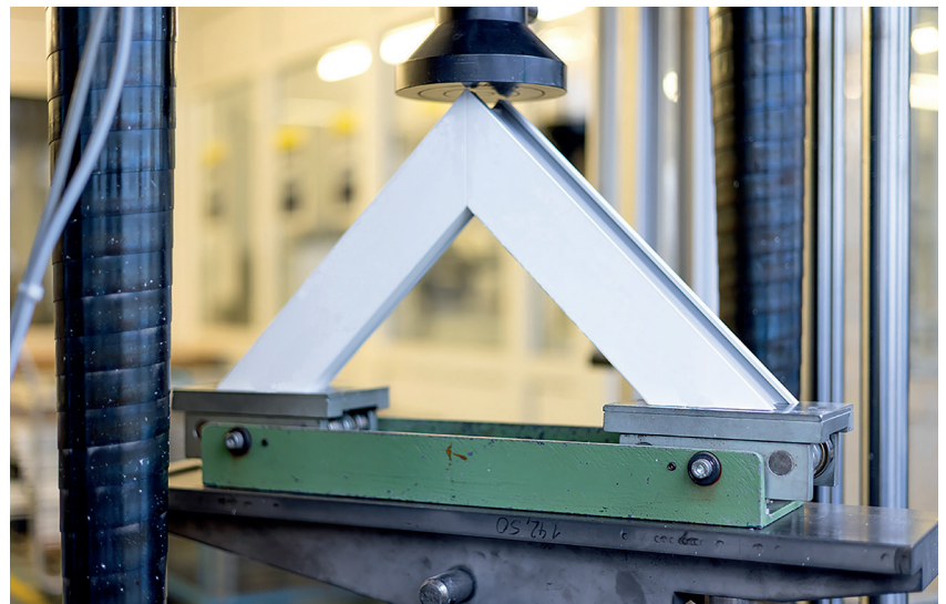
"Wulstlos" geschweißte Ecke in der Prüfung der Schweißbeignung © profine GmbH |
